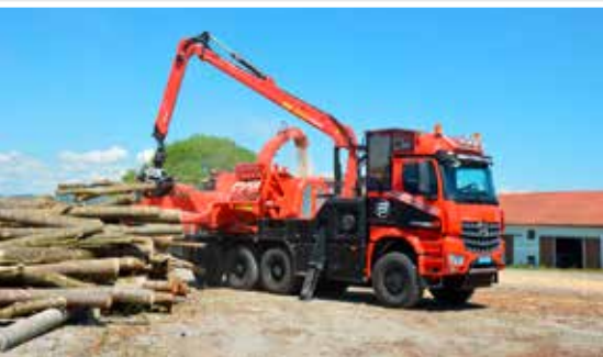
De Turox is een versnipperaar die op een 8x8-Mercedes vrachtwagen staat gemonteerd en diameters tot 75 cm aan kan. De aandrijving wordt verzekerd door een 630 pk-Mercedesmotor.
