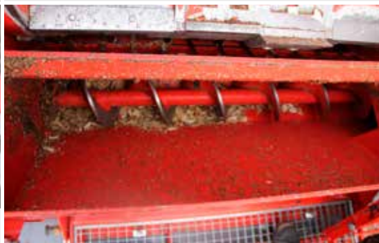
Vijzels draaien het versnipperde product achter de vijzel weg in de richting van de ventilator.
