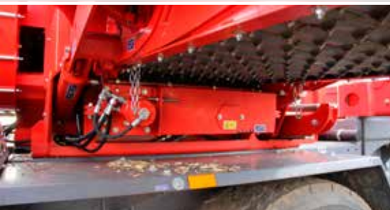
Een rollenbed dat hydraulisch wordt aangedreven transporteert de snippers die tussen de rollen door vallen en brengt ze terug in de materiaalstroom.
