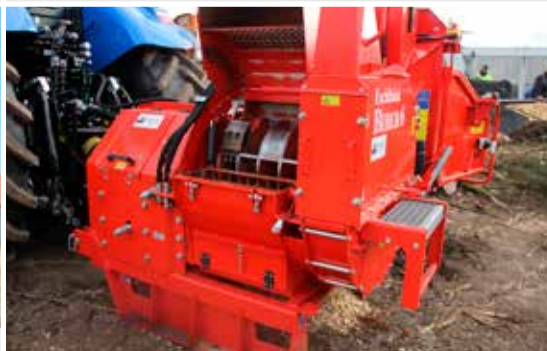
De Biber 6 heeft dezelfde bouwwijze als de grotere machines: een trommel met een doorlopende as die een ventilator aan de rechterkant aandrijft. Het principe van de messen is hetzelfde, de afmetingen zijn iets kleiner.
