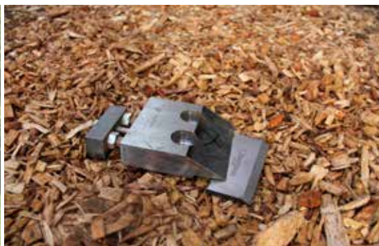
De messen op de Biber 78 zijn eenvoudig te vervangen en uit te regelen. Op de combitrommel kunnen er 6 of 12 gemonteerd worden.
