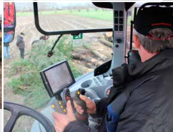
De Biber 78 wordt volledig vanuit de cabine bediend.
