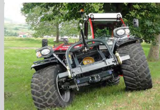
Das hochliegende Pendelgelenk verleiht dem Fahrzeug eine hohe Kippstabilität. Die Anordnung des Pendelgelenks ermöglicht der Vorderachse einen extrem großen Pendelweg
